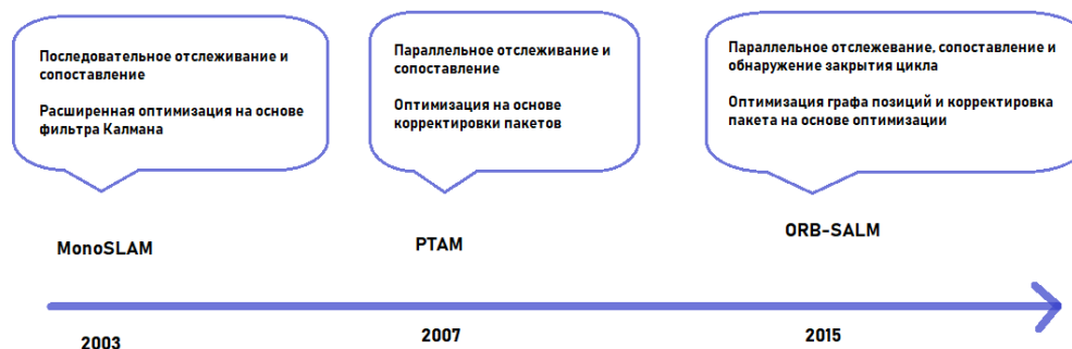
Рис. 1. Алгоритмы, основанные на признаках ( https://link.springer.com/article/10.1186/s41074-017-0027-2/figures/1 )
