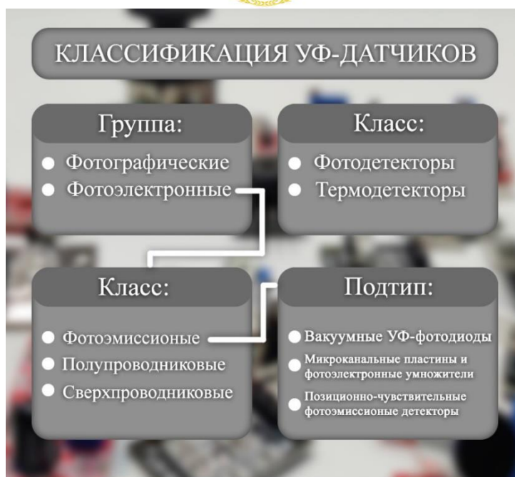
Рис. 2. Классификация датчиков измерения УФ-излучения
