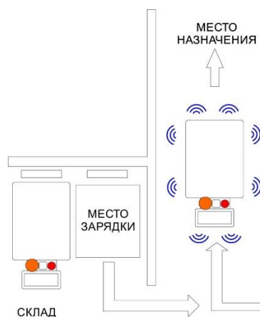
Рис.4. Перемещение грузового робота с использованием ультразвуковых датчиков в навигации
