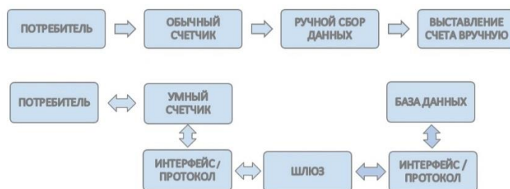
Рис. 2. Архитектурная модель обычного и интеллектуального приборов учета
