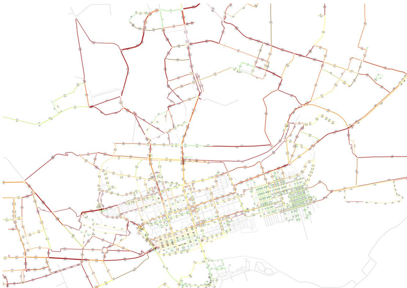
Рис. 2. Условия функционирования участков улично-дорожной сети г. Ростова-на-Дону при соотношении передвижений 90 % личный транспорт –10 % общественный транспорт
