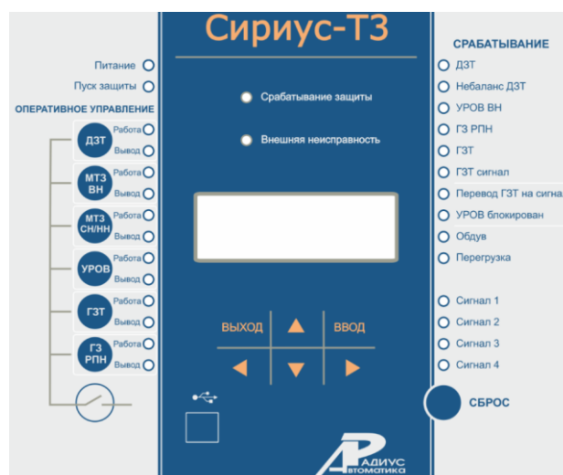
Рис. 2. Панель микропроцессорного устройства защиты «Сириус-Т3»
