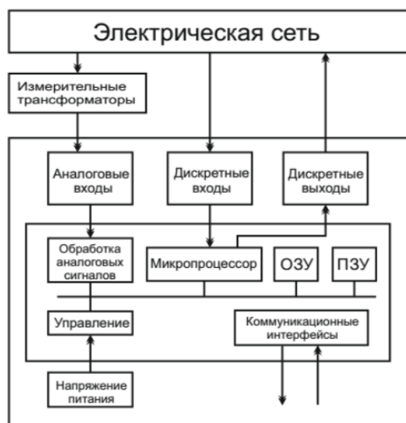
Рис. 3. Обобщенная функциональная схема цифрового устройства токовых защит
