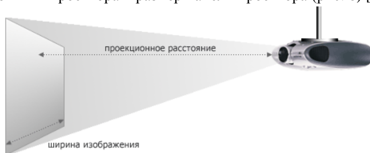
Рис. 8. Схема отношения проекционного расстояния к ширине изображения
