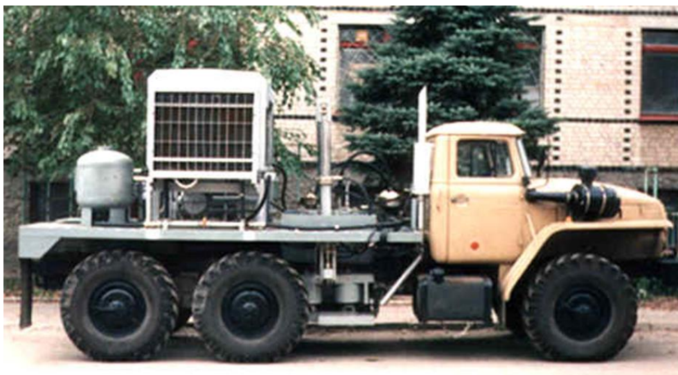
Рис. 1. Мобильный (на базе автомобиля) сеймовибратор СВ-5-150
