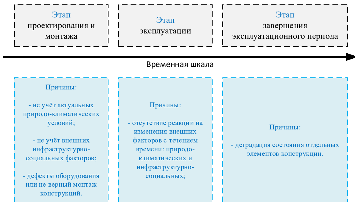
Рис. 2. Этапы существования ВЛЭП с течением времени и соответствующие им причины возникновения повреждений
