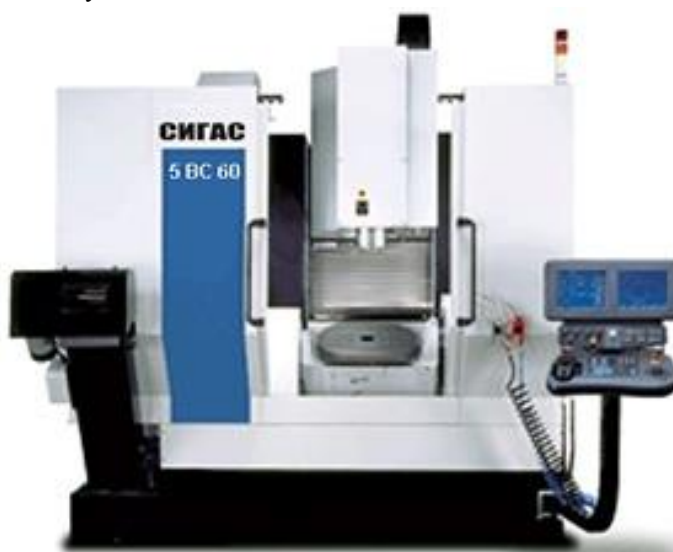
Рис. 3. Пятиосевой обрабатывающий центр СИГАС 5BC60 [6]
