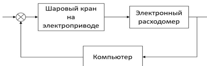
Рис. 1. Схема автоматической регулировки подачи воды
