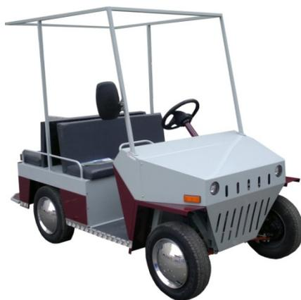
Рис. 1. Внешний вид опытного образца многофункционального электромобиля
