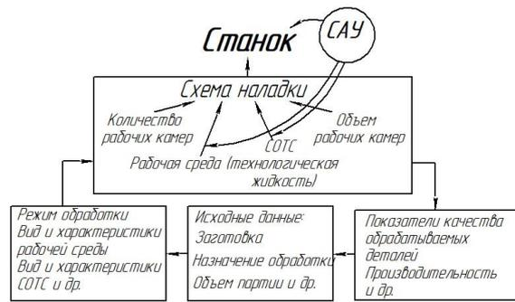
Рис. 2. Структура технологической системы вибрационной абразивной обработки
