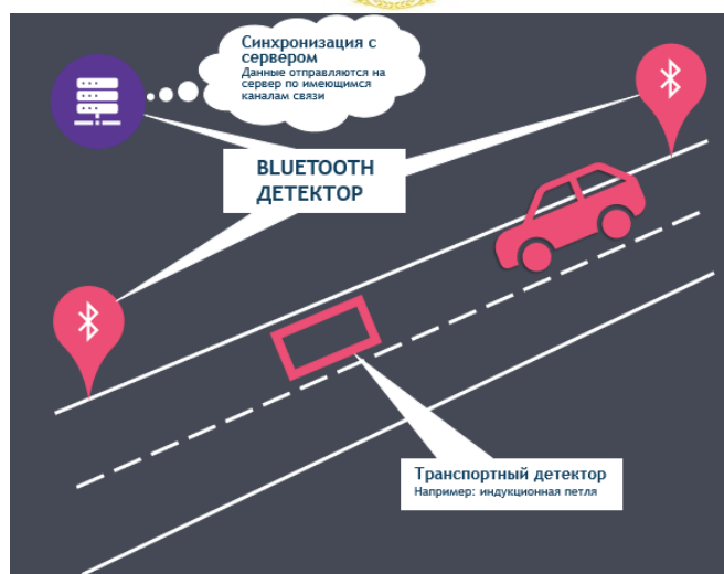
Рис. 1. Мониторинг автомобиля с помощью детекторов на базе Bluetooth
