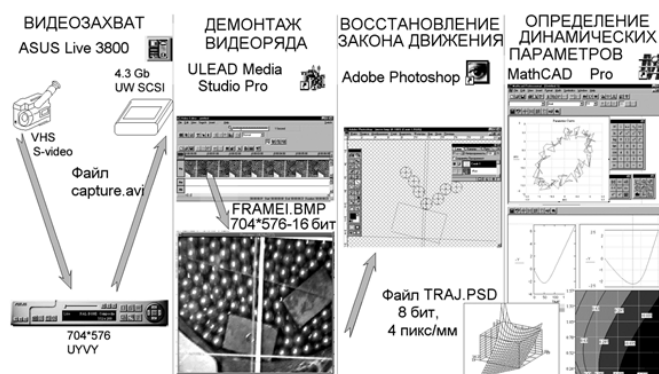
Рис. 11. Схема обработки информации при исследовании динамики рабочей среды в виброкамере
