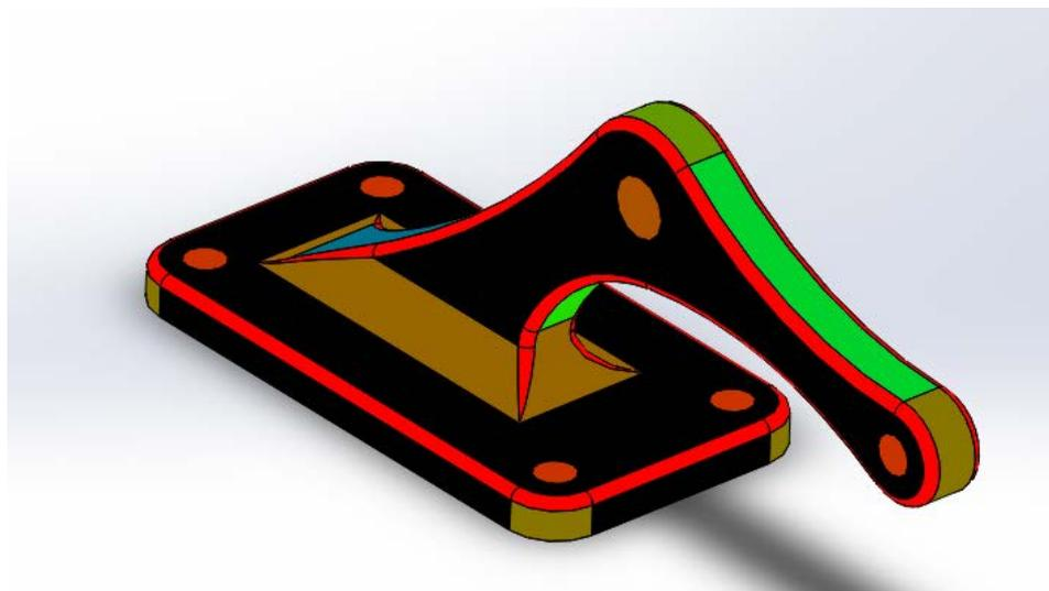
Рис. 8. Анализ кривизны в *SOLIDWORKS*
