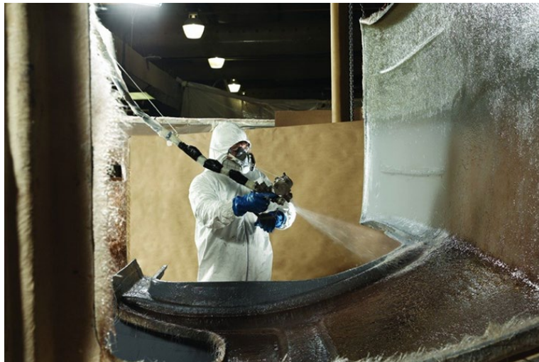
Рис. 1. Процесс напыления стекловолокна на изделие оператором производства стекловолокна, стекловолокнистых материалов и изделий из стеклопластиков
