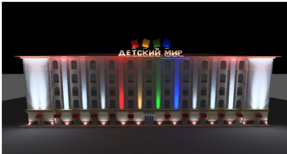
Рис. 3. Освещение фасада ТЦ, спроектированное в DIALux
