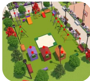
Рис. 20. Места установки датчиков безопасности отмечены красными квадратами
