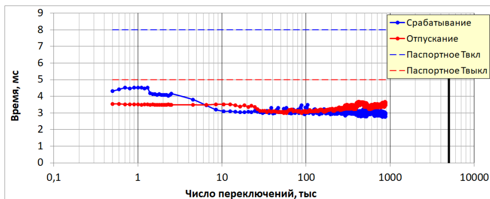
Рис. 8. Время срабатывания и отпускания реле TIANBO
