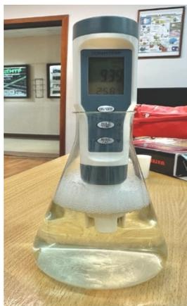
Рис. 2. Измерение рН пенного раствора
