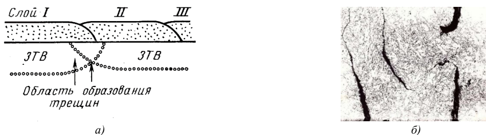
Рис. 1. Области термического влияния, механизм появления трещин: а — визуализация трещин [1], б — X200 [1]
