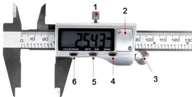
Рис. 2. Устройство цифрового штангенциркуля: 1 — зажимной винт; 2 — батарейка; 3 — ролик изменения длины; 4 — обнуление; 5 — вкл/выкл; 6 — переключение мм/дюймы
