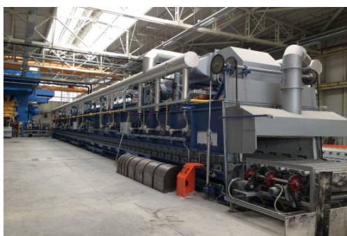
Рис. 5. Линия термической обработки Sistem Teknik, модель HF-EH-A109001-220 [2]
