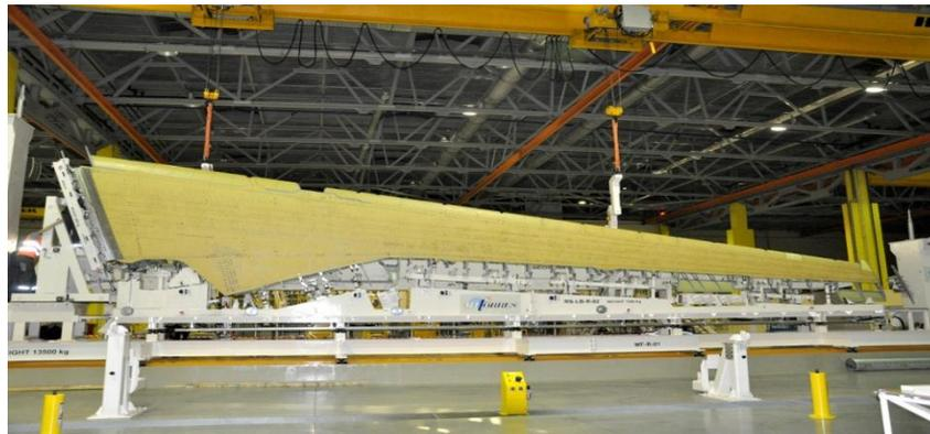
Рис. 1. Консоль крыла самолёта МС-21 на основе композиционных материалов [6]
