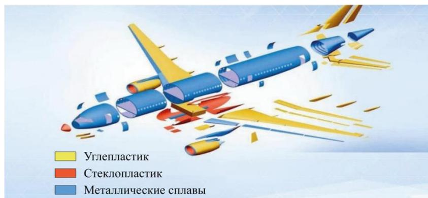
Рис. 2. Распределение материала в конструкции планера [8]
