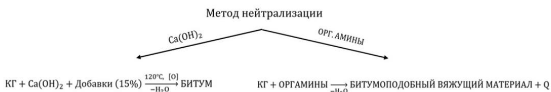
Рис. 4. Переработка КГ методом нейтрализации с использованием органических аминов
