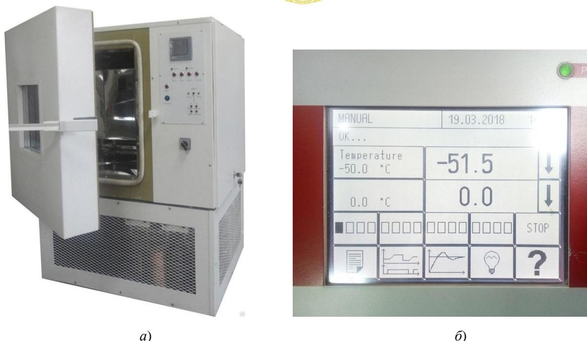
Рис. 5. Установка PSL-4GM: а — общий вид; б — монитор индикации
