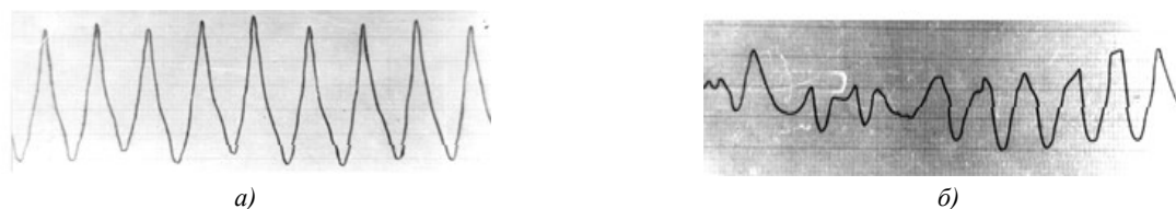
Рис. 4. Профиллограммы поверхностей, снятых с образцов из алюминиевого сплава Д16Т (диаметр индентора — 3 мм, энергия ИУИ — 2,5 Дж) после обработки ШСУ (вертикальное увеличение профиллограммы в 4 000 раз, горизонтальное увеличение в 40 раз): а — исходный микропрофиль; б — микропрофиль поверхности после обработки ШСУ с коэффициентом перекрытия, равным единице
