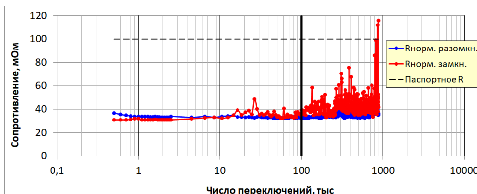
Рис. 7. Сопротивление нормально замкнутых и нормально разомкнутых контактов в замкнутом состоянии реле TIANBO
