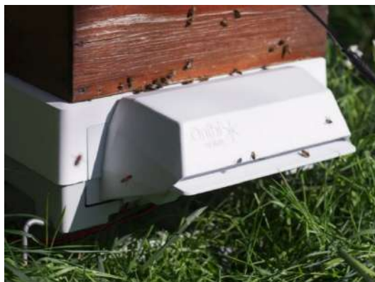
Рис. 2. Роботизированный вход в улей системы Onibi [6]
