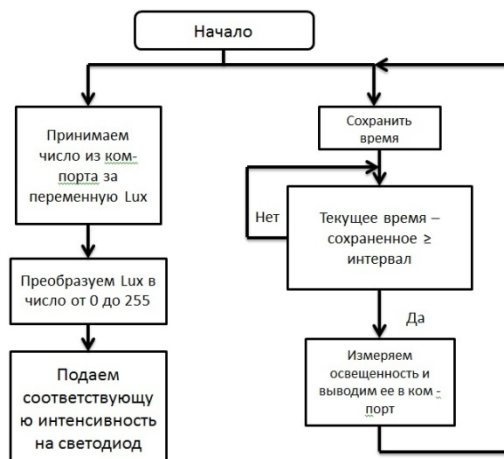
Рисунок 4 – Блок-схема работы устройства
