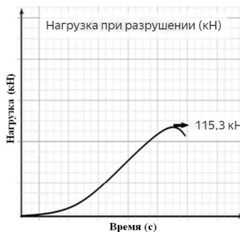
Рис. 3. Кривая зависимости нагрузки от времени, полученная на универсальной испытательной машине (7-дневное затвердевание)
