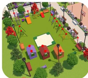
Рис. 20. Места установки датчиков безопасности отмечены красными квадратами
