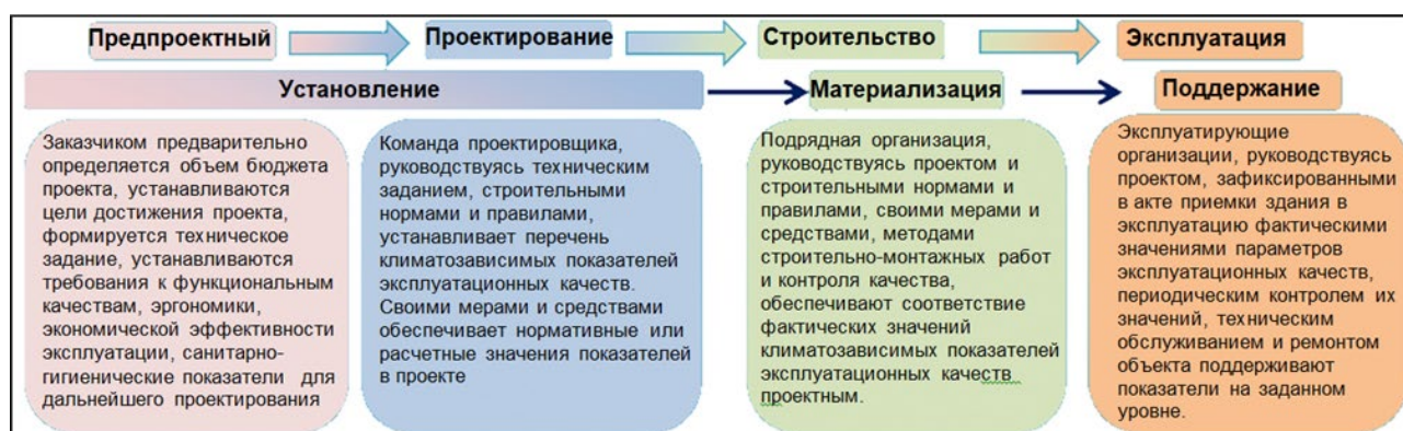
Рис. 2. Схема управления климатозависимыми показателями эксплуатационных качеств на этапах жизненного цикла объекта капитального строительства
