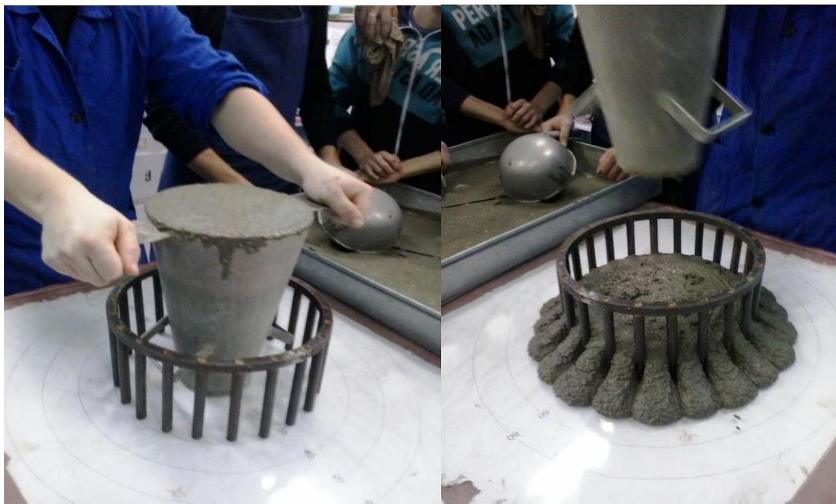
Рис. 2. Определение растекаемости и реологических характеристик самоуплотняющихся смесей
