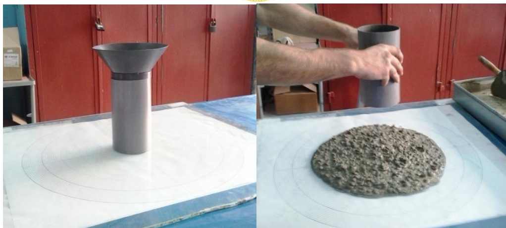
Рис. 2. Прибор для определения предельного напряжения сдвига бетонной смеси
