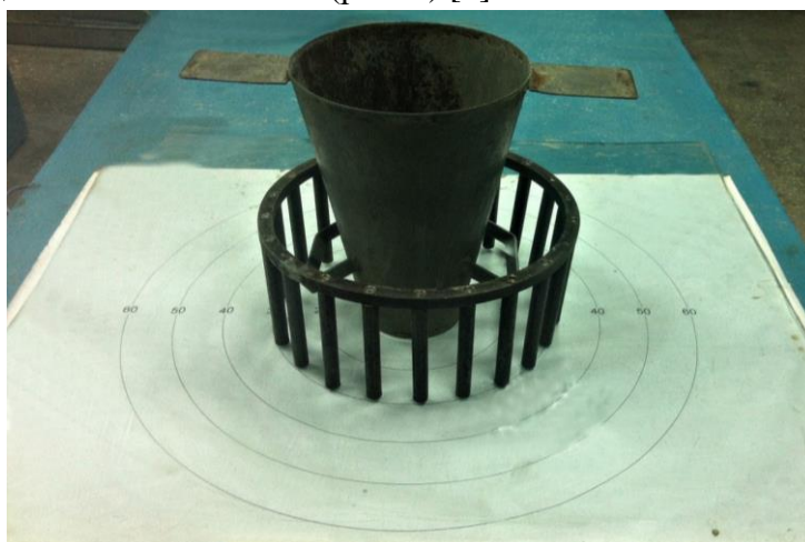
Рис. 1. Прибор для определения растекаемости бетонной смеси
