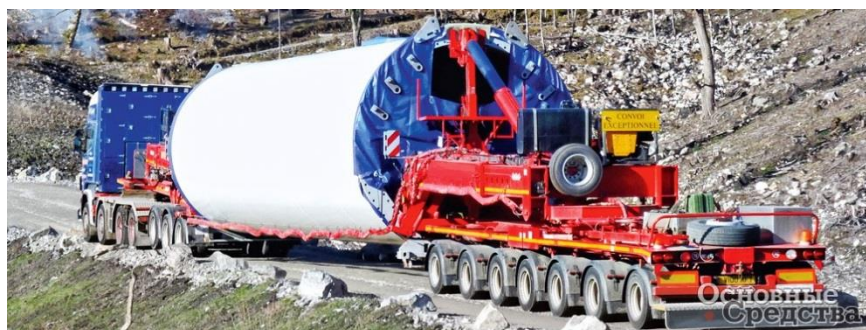
Рис. 3. Nootboom с устройством Mega Windmill Transporter (MWT)
