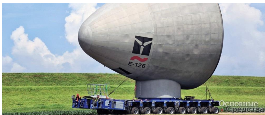
Рис. 2. Башня ВЭУ на платформе самоходного модуля типа Goldhofer
