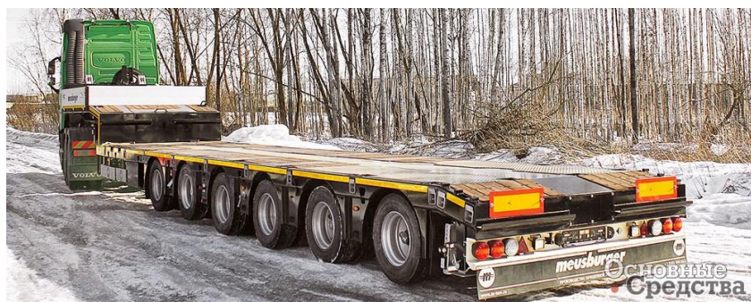
Рис. 5. Шестиосный низкорамный полуприцеп Meusburger Новтрак TP-697с задним заездом
