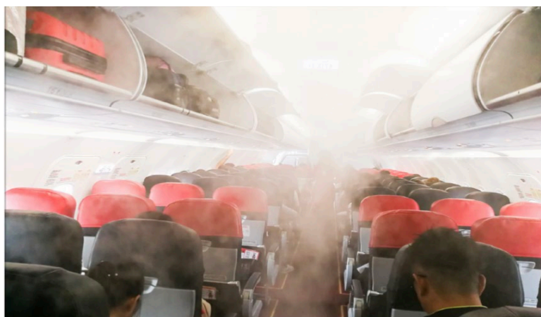
Рис. 2. Конденсация влаги в салоне самолета при взаимодействии теплого внешнего воздуха с охлажденной средой кабины [5]
