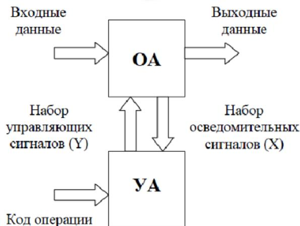
Рис. 1. Модель цифрового автомата
