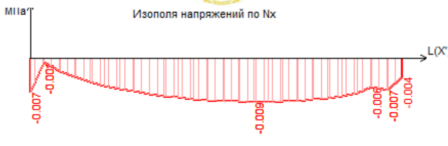
Рис. 7. Эпюра напряжений \sigma_x при z = 3.2 м (в заземлении), полученная в ПК ЛИРА
