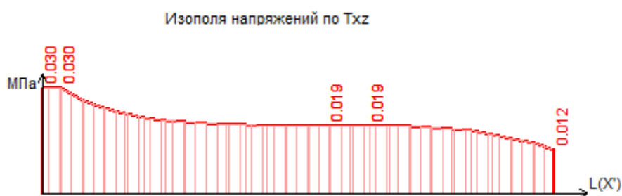
Рис. 9. Эпюра напряжений \tau_{xz} при z = 3.2 м (в заземлении), полученная в ПК ЛИРА
