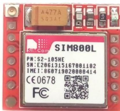
Рис. 9. Модуль связи SIMCom SIM800L
