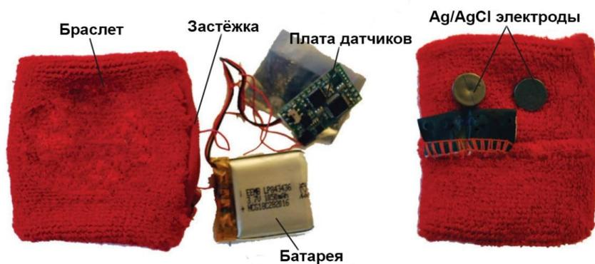
Рис. 3. Внешний вид устройства регистрации приступа эпилепсии на основе экзосоматического метода измерения электрической активности кожи
