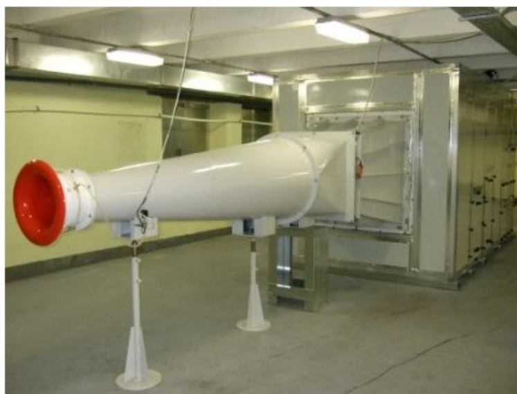
Рис. 1. Стенд для определения аэродинамических характеристик вентиляционных клапанов
