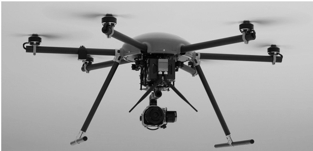
Рис. 1. Квадрокоптер, оснащенный видеокамерой
