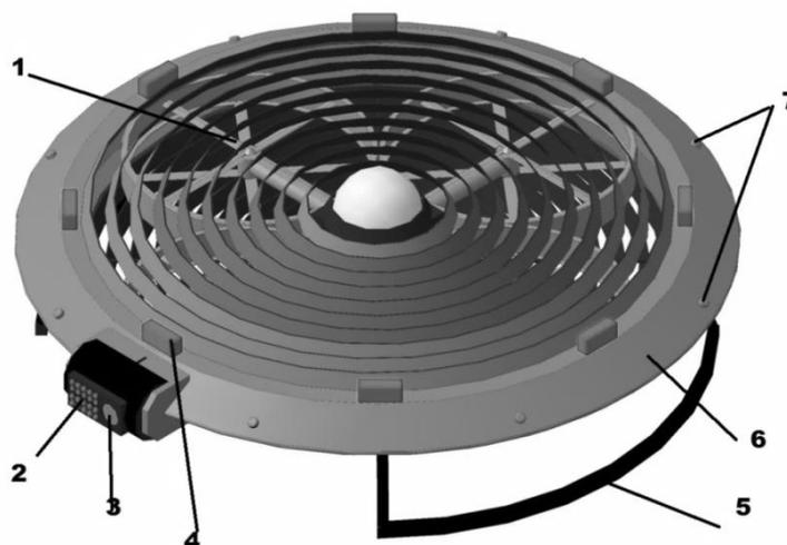
Рис. 3. Общий вид 3D-модели беспилотного летательного аппарата: 1 — бесколлекторные двигатели постоянного тока; 2 — бесконтактный температурный модуль-зонд; 3 — модуль камеры; 4 — датчики Холла;
