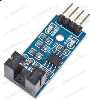
Рис. 5. Модуль датчика оборотов RKP-MWES-LM393
