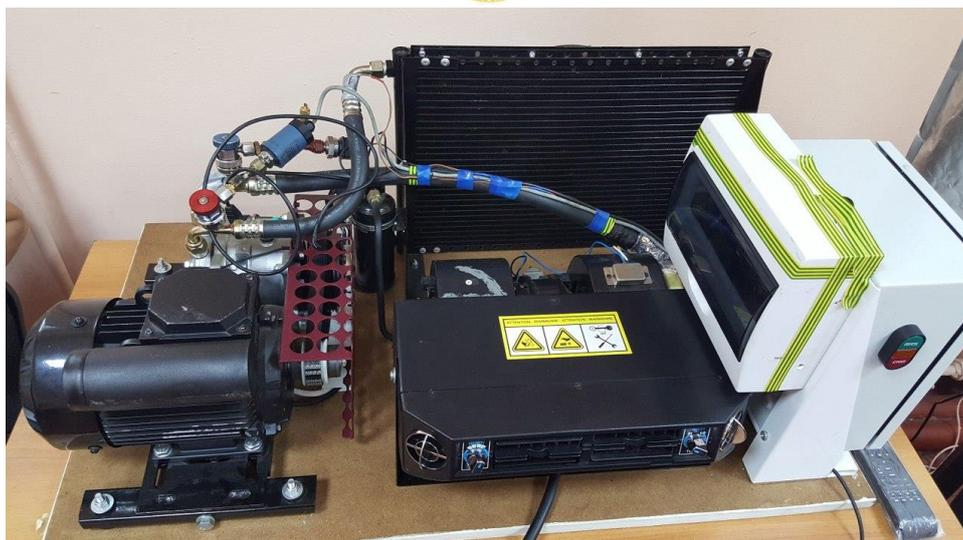
Рис. 1. Стенд-тренажёр по исследованию основных термодинамических параметров автомобильного кондиционера
