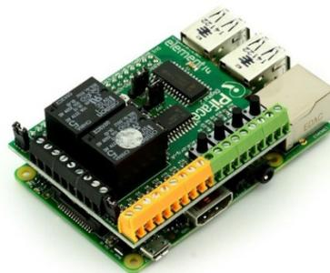
Рис. 7. Плата расширения PiFace Digital 2
