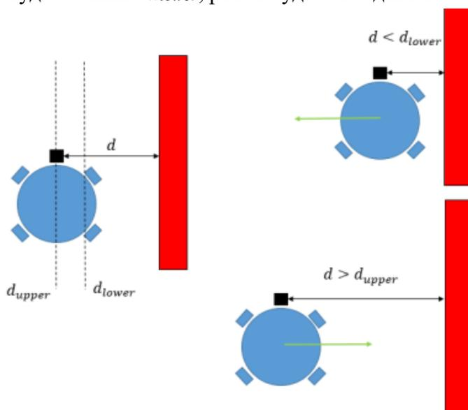
Рис. 4. Стратегия алгоритма следования робота вдоль стены
