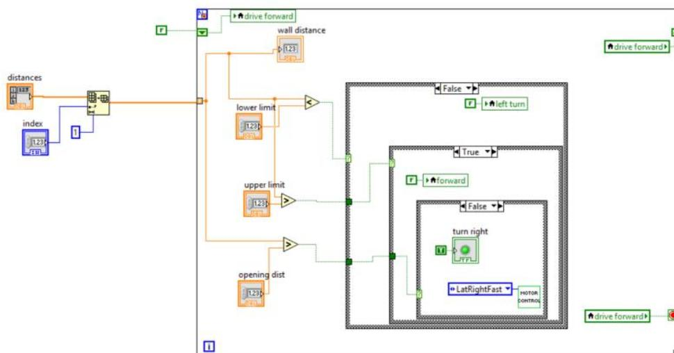
Рис. 5. Пример программной реализации алгоритма следования вдоль стены
