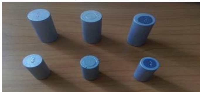
Рис. 2. Образцы из дюралюминия Д16Т
