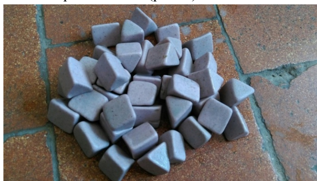
Рис 3. Трёхгранные призмы ПТ 15×15 мм, зернистостью 16
