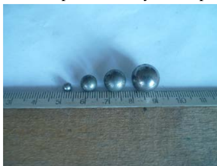
Рис. 2. Рабочая среда — шары из стали ШХ 15
