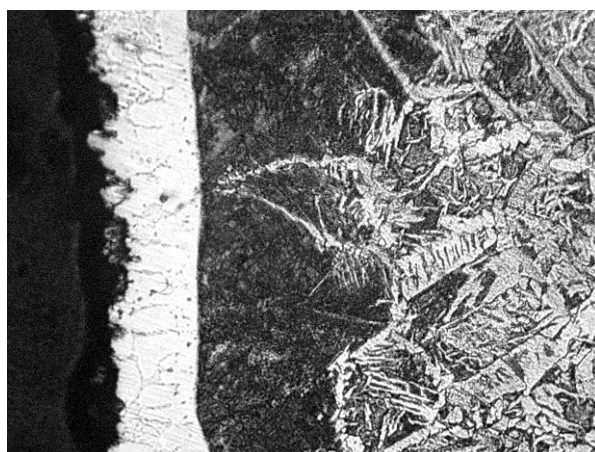
Рис. 1. Борохромованный слой на поверхности стали 20 после МДХТО
