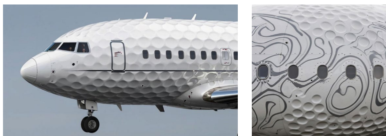
Рис. 2. Модель обшивки самолета с углублениями для улучшенной аэродинамики
